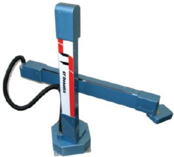
Cylindrical robot (RPP)
